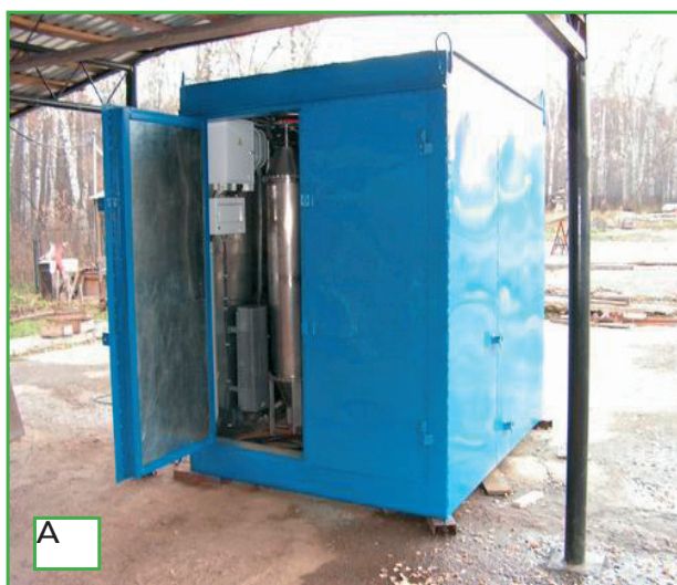
Рис. 1. Общий вид (А) и компоновка узлов (Б) малогабаритной блочно-модульной станции очистки воды по патенту
