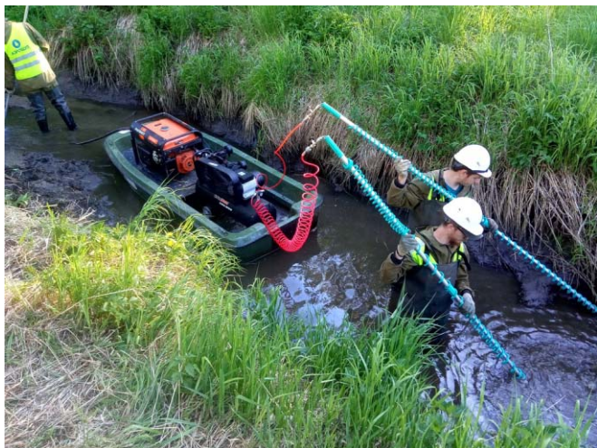
Рис. 2. Сотрудники Биологического института ТГУ проводят опытно-промышленные работы по очистке дна ручья Малый Войвож от нефтяных углеводородов.
